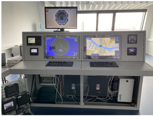
Abbildung 1. Labor-Schiffsbrücke mit Radar, ECDIS, AIS, GNSS, und VDR.
