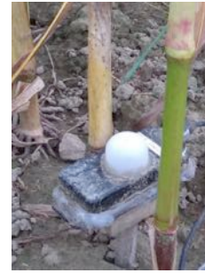
(c) Mud on a ground-level PAR sensor.
